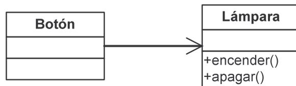
Tal como está diseñado, no será posible utilizar el botón para encender, por ejemplo, un motor (ya que el botón depende directamente de la lámpara que enciende y apaga).
